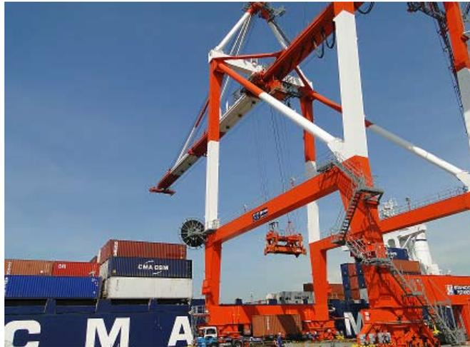
手際良く、コンテナを本船に積み込むガントリークレーン
