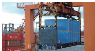
2 ガントリークレーンにて吊り上げ 荷役中
