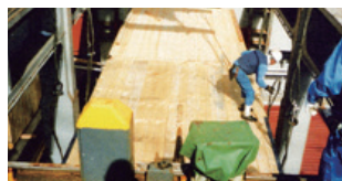
3 アンダーデッキショアリング積み付け中
